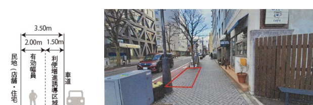
図－4 左：市道1059号線の断面図，右：市道1059号線の指定箇所の様子 ②
